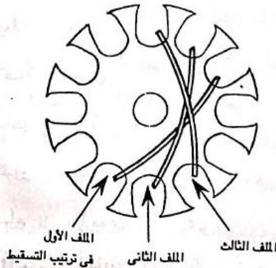
وتتميز هذه الطريقة بالسهولة وعدم التعقيد ولكن العيب الخطير لها انها تؤدي إلى فقد إتزان البوبينة حيث أن بناء الملفات فوق بعضها بشكل متتابع هكذا يؤدي إلى أن الملفات الأولى التي تم تسقيطها أولاً تكون أقل حجماً وبالتالي أخف وزناً من الملفات الأخيرة التي تم تسقيطها وأخر عملية التسقيط ولذلك لا تستخدم إلا في بوبينات المحركات ذات القدرات الصغيرة لأن هذه البوبينات يكون وزنها أصلاً صغيراً وأيضاً فإن أوزان الملفات بها يكون صغيراً وبالتالي فإن عدم الإتزان في هذه الحالة ليس له تأثير واضح :
